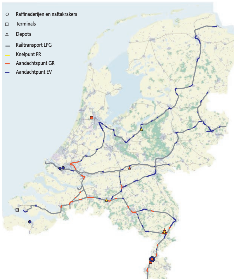
Kaart 3 Overzicht van LPG-producenten en LPG-depots in Nederland, en van PR-knelpunten, GR- en effectgerichte aandachtspunten voor het LPG-railtransport (2010).
