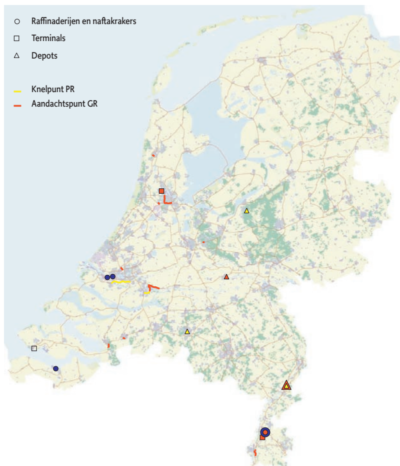
Kaart 5 PR-knelpunten, de GR- en effectgerichte aandachtspunten voor het LPG-wegtransport, als de tankwagens worden uitgerust met een hittewerende coating (2010).
